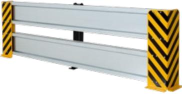
PRO-Safe DRP3200 Rammschutzplanke unverzichtbar beim Einsatz von Kommissionier-Staplern zur Sicherung von Anlagen, Fahrwegen, Regalanlagen u. v. m. Gesamthöhe 900 mm, 2 Leitplanken à 350 x 3.000 mm inkl. 2 Rammschutzecken 900 x 256 x 6 mm und Mittelpfosten 900 mm hoch (pulverlackiert); zur Versteifung der Rammschutzplanke inkl. Beton-Schwerlast-Schraubanker und Montagematerial.
