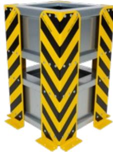
Die Konstruktion kann horizontale Belastungen bis zu 2.000 kg (20,0 kN) ohne merklich bleibende Verformungen oder Beeinträchtigungen der weiteren Schutz-funktion aufnehmen. Unentbehrlich in jeder Produktionshalle, bis 3.000 x 3.000 mm lieferbar.
