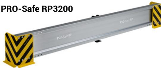
Rammschutzplanke zur Sicherung von Anlagen, Fahrwege, Regalanlagen u.v.m. Gesamthöhe 400 mm, Leitplanke 350 x 3.000 mm inkl. 2 Rammschutzecken 400 x 256 x 6 mm und Mittelpfosten 400 mm hoch, (Pulverlackiert) zur Versteifung der Rammschutzplanke inkl. Beton- Schwerlast-Schraubanker und Montageschrauben.
